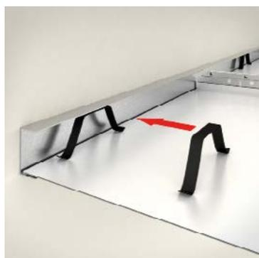
Appuyer légèrement sur le ressort pour l'aplatir puis le glisser dans le profil. Relacher le ressort pour serrer le montage.
