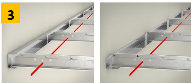
3. MISE EN OEUVRE DES PORTEURS
