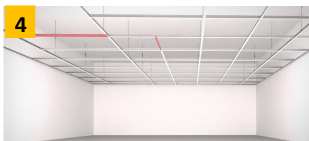
4. MISE EN OEUVRE DES ENTRETOISES
