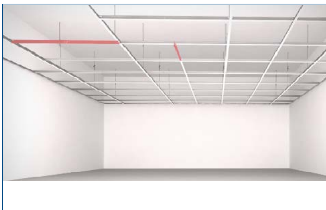
4. Mise en œuvre des entretoises
