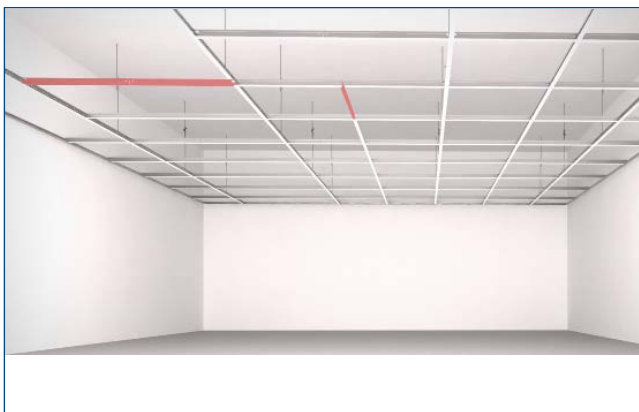
4. Mise en œuvre des entretoises
