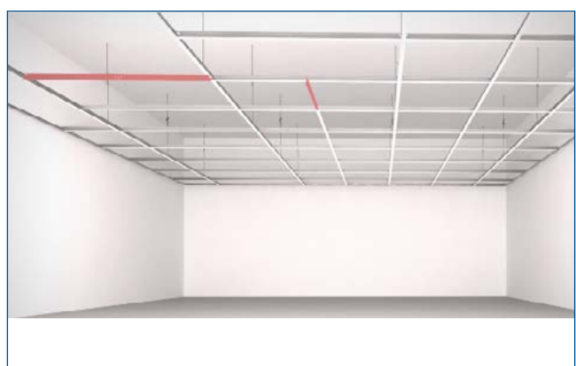
4. Mise en œuvre des entretoises
